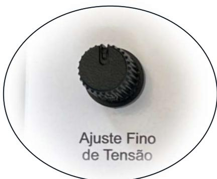
Ajuste Fino de Tensão, após ligar o Gerador, ajuste a Tensão de saída para 220V.
