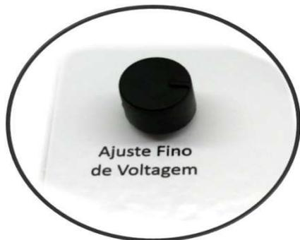
Ajuste Fino de Voltagem, após ligar o Gerador, ajuste a Tensão de saída para 220V (ou 254V).
